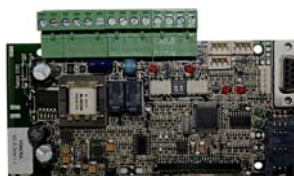
VSN-CRA Scheda opzionale Modem (Contact ID) per la connessione remota e porta RS.232
