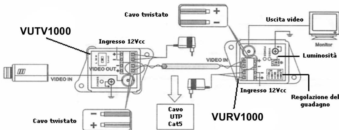
**Nota:** si consiglia in abbinamento, l'utilizzo degli scaricatori di tensione per evitare danneggiamenti alle apparecchiature dovuti a possibili interferenze.
