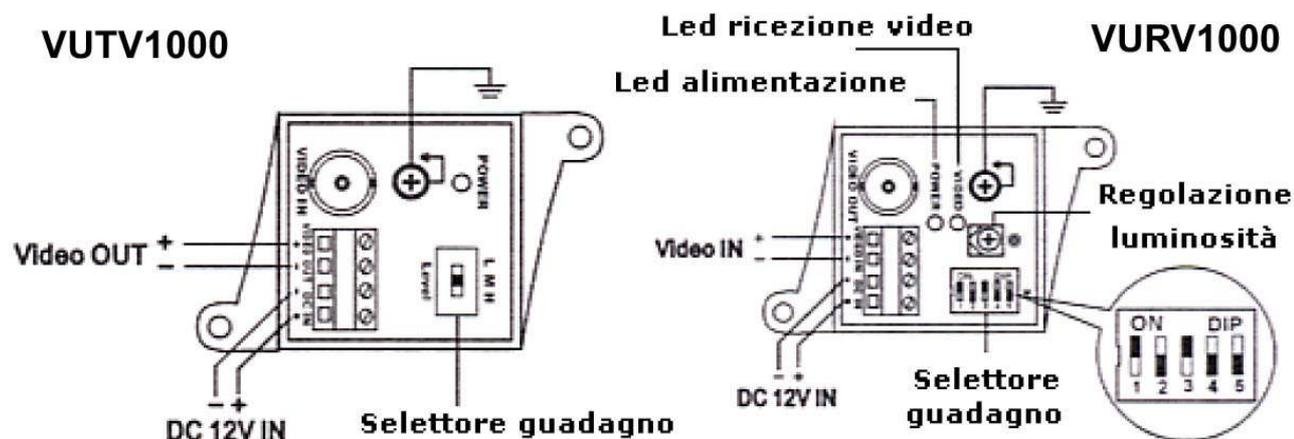
Posizione Dip switch (sul ricevitore)
