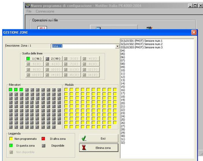
Le programmazioni che possono essere eseguite con questo programma sono le stesse che l'operatore può eseguire lavorando direttamente sulla centrale. Compatibile con tutte le versioni di Windows. Connessione alla centrale con linea seriale RS-232.
