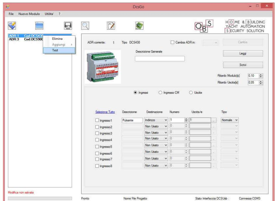
Comparirà nella schermata di destra la pagina di test del dispositivo dalla quale si potranno controllare lo stato degli ingressi e delle uscite o parametri specifici del dispositivo.
