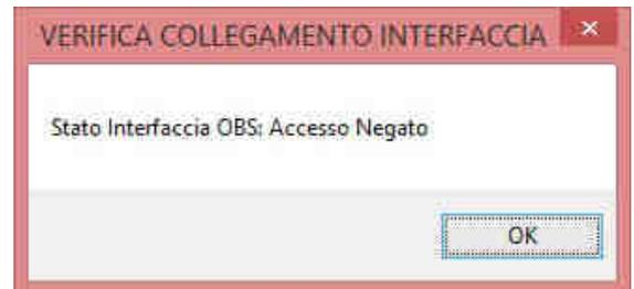
Dopo aver collegato correttamente il dispositivo d'interfaccia, per attivare la connessione con il bus selezionare la voce "VERIFICA COLLEGAMENTO INTERFACCIA" dal menù "UTILITA'"
